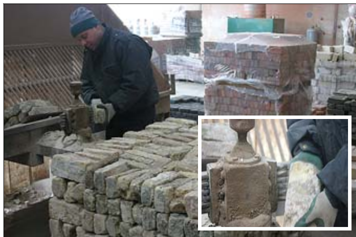
Recuperatiestenen worden een voor een gekeurd en vrijgemaakt van mortelresten. Hiervoor gebruikt men een beitelmachine (zie inzet)
